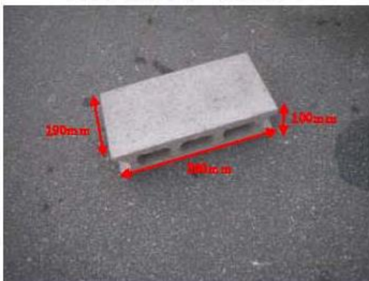
試験片 (コンクリートブロック)
