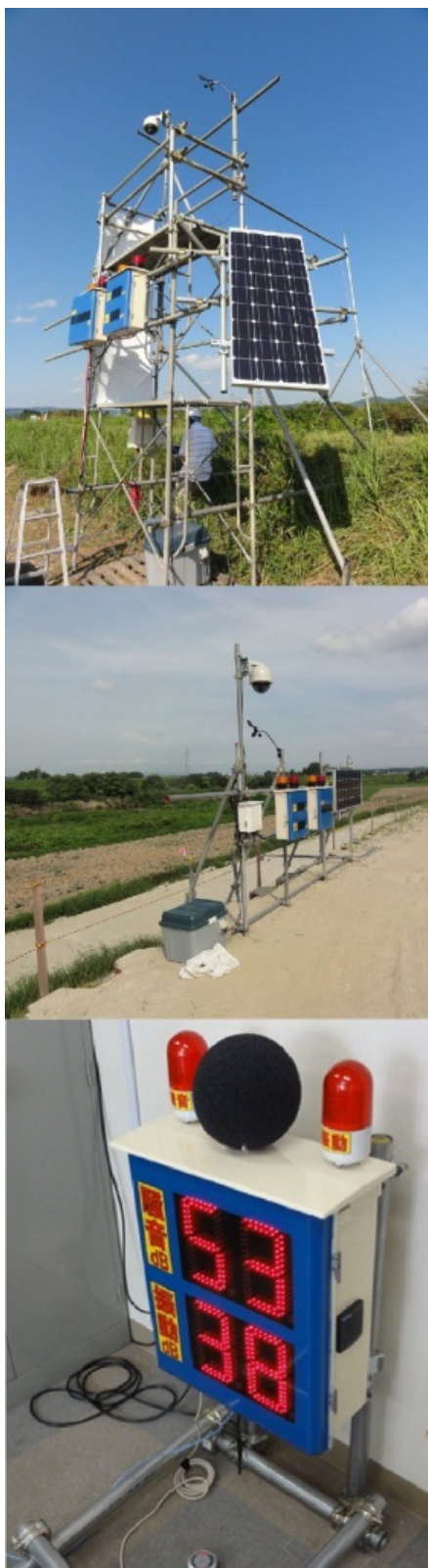
水位、風速、振動、騒音、Web監視カメラ等設置例
